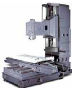
DMC-1600/1900 с четырьмя направляющими коробчатого типа
