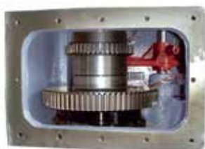
Встроенный зубчатый редуктор, 6000 об/мин (BT-50)
