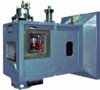
Встроенный зубчатый редуктор, 6000 об/мин (BT-50)
